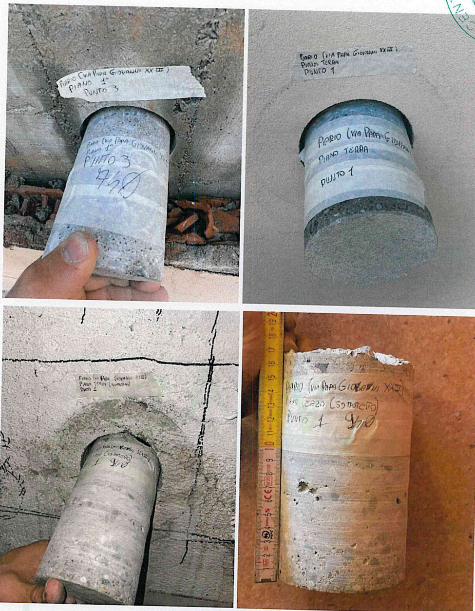
Foto: esempi di prelievo campioni attraverso carotaggio
